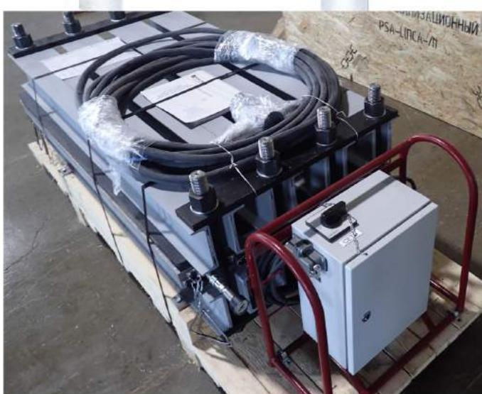
Тип стыка - прямоугольный ( $90^\circ$ ), максимальная ширина ленты (типоразмер пресса) до 1400мм.
